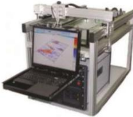
3.1-сурет - Ультрадыбыстық бақылау үшін IDEalSystem3D стационарлық жүйесі
